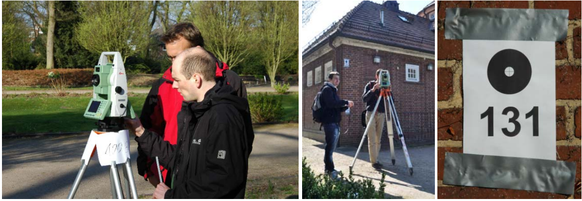
Aufnahme eines 3D-Netzes um die Trinkhalle (links) und Vermessung der signalisierten Passpunkte am Gebäude (Mitte)
