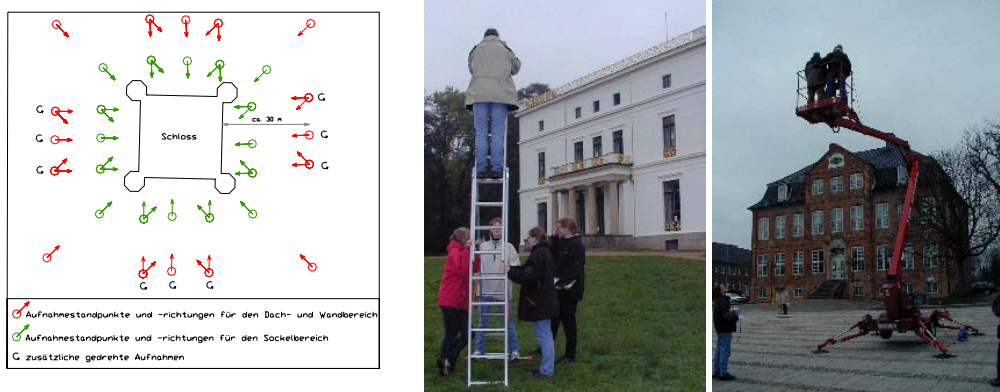
Abb. 3: v.l.n.r. Aufnahmekonfiguration Ahrensburger Schloss, Aufnahme am Jenisch Haus Hamburg und Hebebühne für die Aufnahme der Landdrostei Pinneberg
